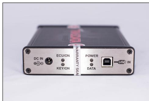
**KEY/ON:** Indicador luminoso del estado de la alimentación eléctrica del subpanel de la centralita.
