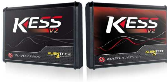
Figura 37: Programador serial de centralitas electrónicas versión Slave y Master .
