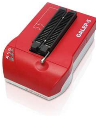
Figura 3: Programador de memoria en el circuito integrado; Galep .
